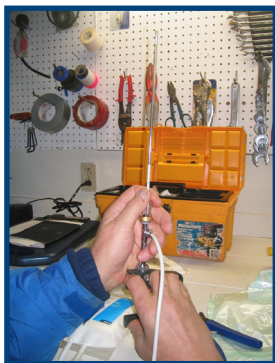
Bilde 5 – Kalibrering av sprøyte med lang 1 ml pipette
